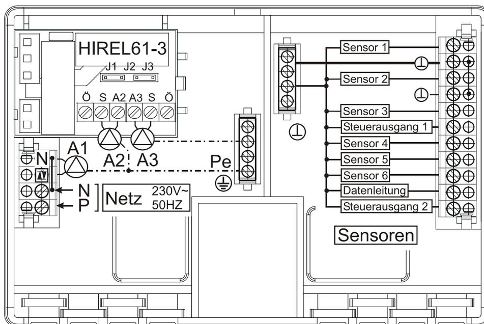
Das Relaismodul wird in der linken oberen Ecke der Grundplatte eingesetzt. Zuerst wird die Leiterplatte bis zum Anschlag unter die beiden Noppen in der linken Gehäusewand geschoben und danach auf der anderen Seite nach unten gedrückt, bis sie einrastet. Eine eigene Verbindung zur Netzspannung ist nicht notwendig, da diese über die Stiftheisten der Deckelplatte besteht.
