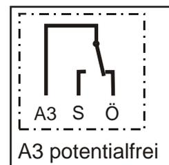
Mit den **Steckbrücken** (Jumper J1 bis J3) lässt sich der Ausgang **A3** potentialfrei machen. Dazu wird an Stelle von J1 und J3 (Standard) die Brücke **J2** gesteckt, wobei der Anschluss A3 die Wurzel ist.
